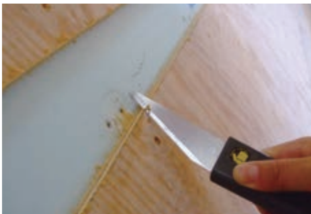
切り抜いた溝のヒーター側のバリをとる
